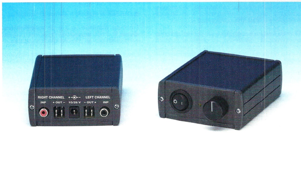
Fig. 1 Ecco come si presenta l'amplificatore in classe D LX.1794 a montaggio concluso.
