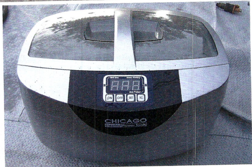
Fig.11 Piccola lavatrice ad ultrasuoni utilizzata per eliminare impurità ed incrostazioni presenti sugli iniettori.
